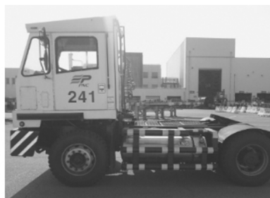
개선 후 LNG 야드 트랙터
